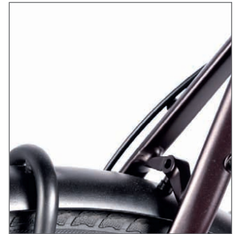
Besser als Streben: Der stabile Rad-Schutzler wird über Kurz-Stege fixiert.
