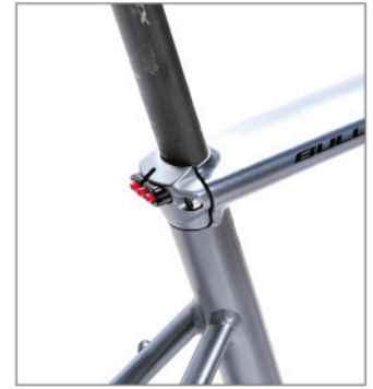
Edel: Die drei leuchtstarken LEDs sind in die Klemmung integriert.
