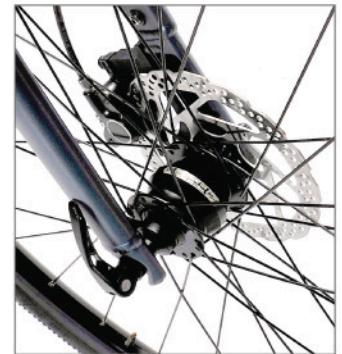
Der Shutter-Nabendynamo: klein und wirkungsvoll
