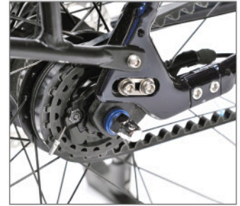
Lautloser Lauf, ölfrei, bemerkenswerte Optik: Riemenantrieb
